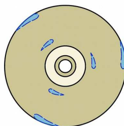
Figura 7.1.11 - Disposição do espaçadores “tipo-aerofólio” nos rotores
