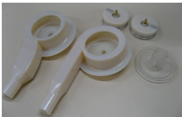
Figura 7.3.6 - Componentes fabricados para a mini bomba Tesla
