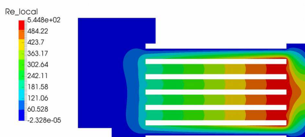
Figura 8.1.10 - Número de Reynolds local com relação ao raio externo dos discos (para malha de resolução 256)
