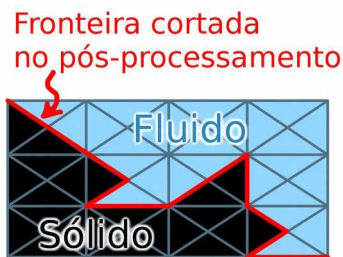
Figura 8.5.29 - Exemplo de fronteira da malha filtrada (pós-processada)
